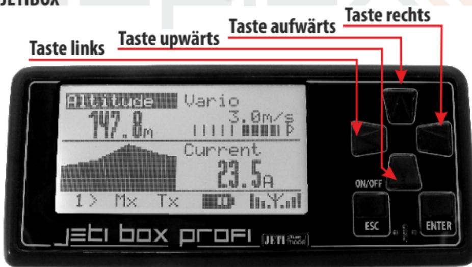
Taste linksTaste upwärtsTaste aufwärtsTaste rechts
