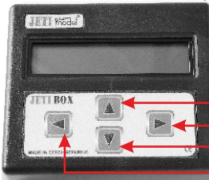
Taste Aufwärts UTaste rechts RTaste abwärts DTaste links L**JETIBOX**
