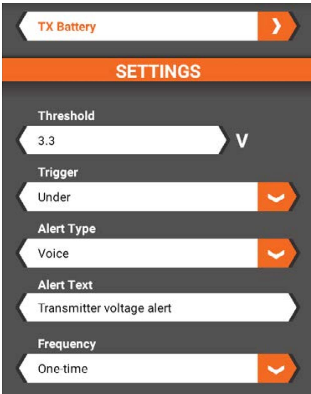
Per impostare la soglia di tensione dell'avviso della batteria della trasmittente:
