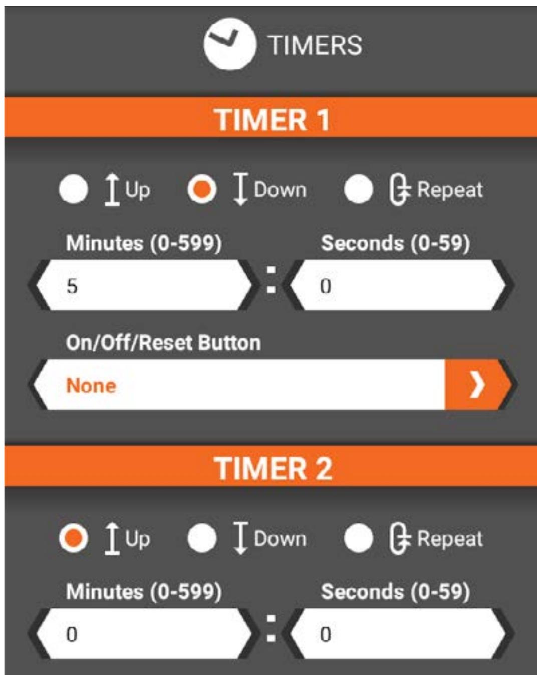
Toccare la voce Timer dal menu di setup per configurare i timer e cancellare il contatore parziale per il modello e quello totale della trasmittente.
