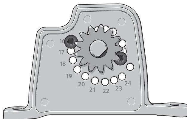
**IMPORTANT :** L'engrenage à pignons 16T fourni est adapté pour les batteries Li-Po 6S ou 8S.
