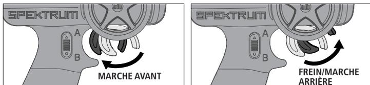
5. Poussez le déclencheur de l'émetteur sur plein frein, arrêtez, puis remettez le déclencheur au centre.
