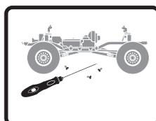
Verificare la presenza di viti allentate sul telaio, in particolare le viti di blocco dello snodo, del mozzo centrale e dell'assale
