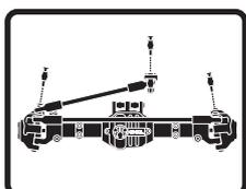
Verificare l'usura dei giunti sferici delle bielle dello sterzo e delle sospensioni (sostituirli se necessario)
