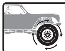
Verificare che la trasmissione operi in modo fluido e senza impedimenti
