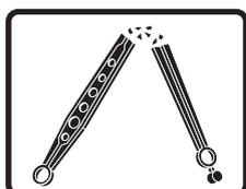
Sostituire eventuali componenti visibilmente piegati o danneggiati
