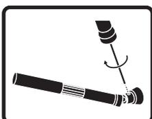
Verificare le viti di fissaggio dell'albero di trasmissione e applicare dei frenafili se necessario
